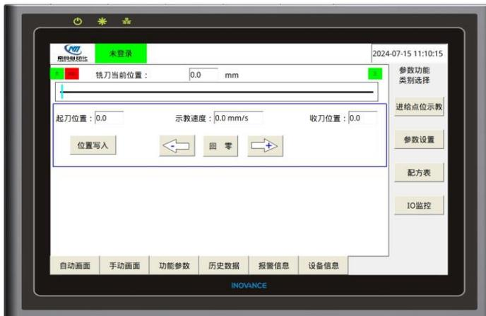
登录密码后再次点击菜单栏中“功能参数”按钮方可进入到参数页面。进入参数的第一个画面是进给点示教页面，注意，此画面示教速度设定、起刀位置设定、收刀位置设定，须在手动模式下进行。也可以直接修改位置数据。
