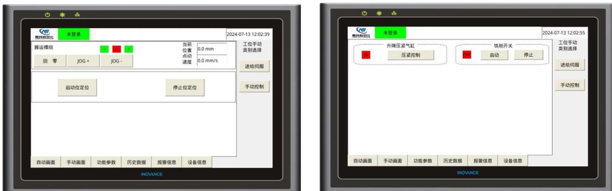
手动控制：用于手动模式下的气缸控制和铣削刀头旋转的手动控制。
